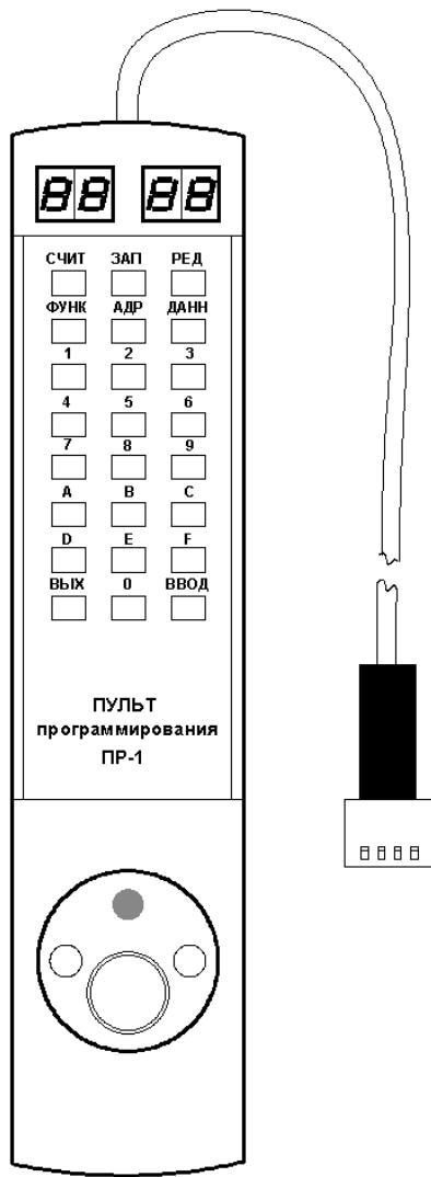
– Пульт подключается к разъему ХР1 прибора «Аб». При успешном подключении пульта программирования к прибору на индикаторе высвечивается надпись **Pt-3**.
